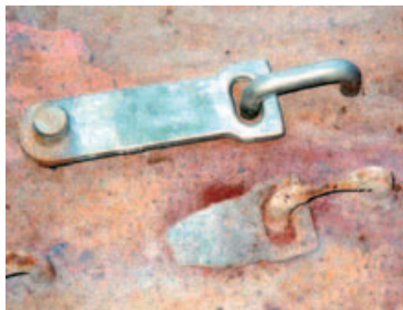
La photographie ci-dessus présente une pièce en alliage CrNi 25 20 et une pièce revêtue de la poudre 53606, toutes deux après 12 mois de service.
